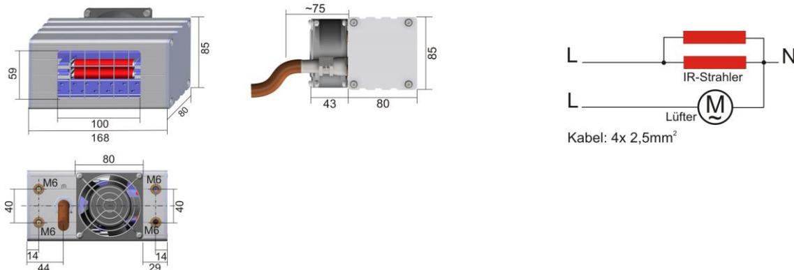
**IRD S160D** – 3 x 0,3 kW / 230 V (50/60 Hz);
