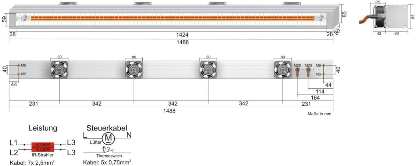
**IRD E1480Z** – 2x 8,5 kW / 400 V + N + PE (50/60Hz);
