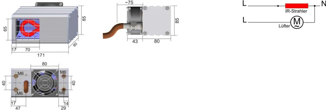
**IRD S160Z** – 2 x 0,3 kW / 230 V (50/60 Hz);
