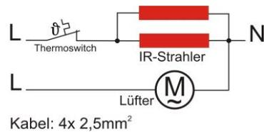
**IRD E270D** - 3x 0,5 kW / 230 V (50/60Hz);
